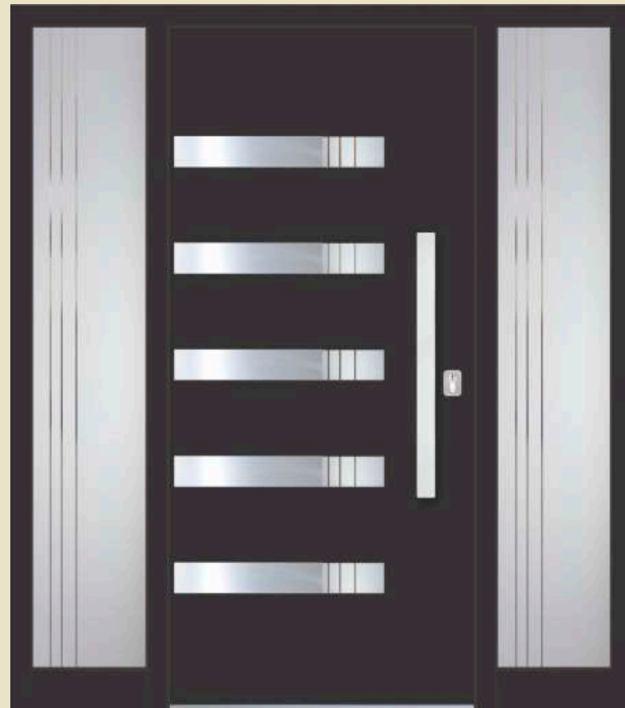
vanjska ploča AL punto grigio unutrašnja ploča AL punto grigio staklo DPC - pjeskareni motiv na float staklu + 2 dosvjetla DPC aplikacija INXP-vanjski rukohvat DPS 750h rozeta RKP 50
