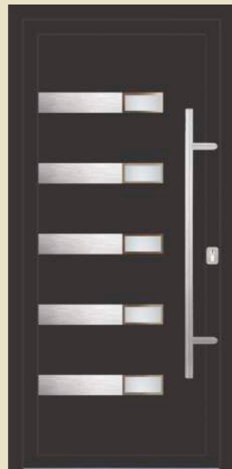
vanjska ploča AL punto grigio unutrašnja ploča AL punto grigio staklo FPK - pjeskareni motiv na float staklu aplikacija INXC-vanjski rukohvat OCS 115h rozeta RKP 50
