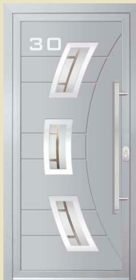
vanjska ploča AL 9006 sjaj unutrašnja ploča AL 9006 sjaj staklo POT - pjeskareno float staklo s olovnom trakom aplikacija INXP-vanjski rukohvat KPS 950h rozeta ROP 50 kućni broj BDP 10
