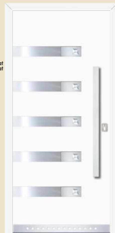
vanjska ploča AL punto grigio unutrašnja ploča AL punto grigio staklo DPC - pjeskareni motiv na float staklu + 2 dosvjetla DPC aplikacija INXP-vanjski rukohvat DPS 750h rozeta RKP 50
