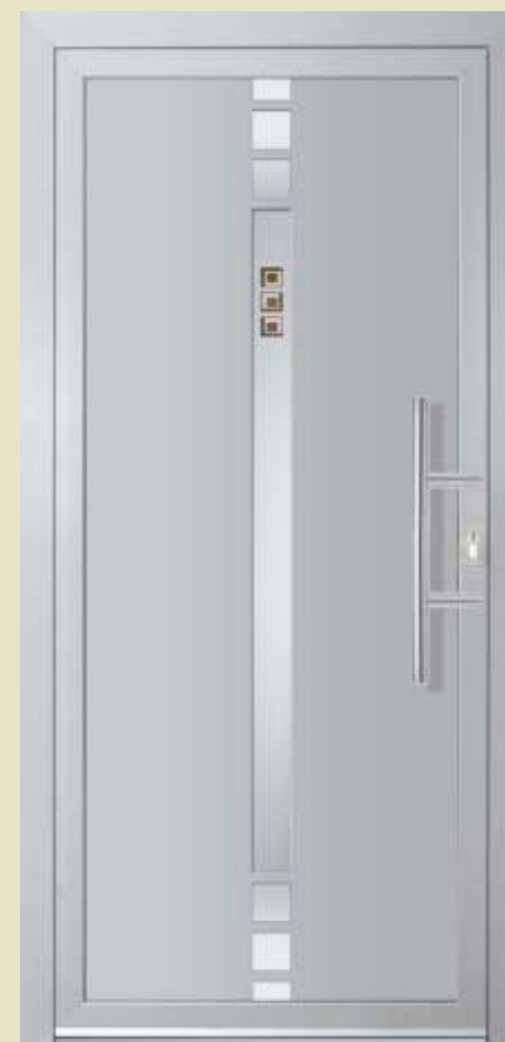
vanjska ploča AL 9006 sjaj unutrašnja ploča AL 9006 sjaj staklo PPF - pjeskareni motiv na float staklu aplikacija INXP-vanjski rukohvat OPS 550h rozeta RKP 50
