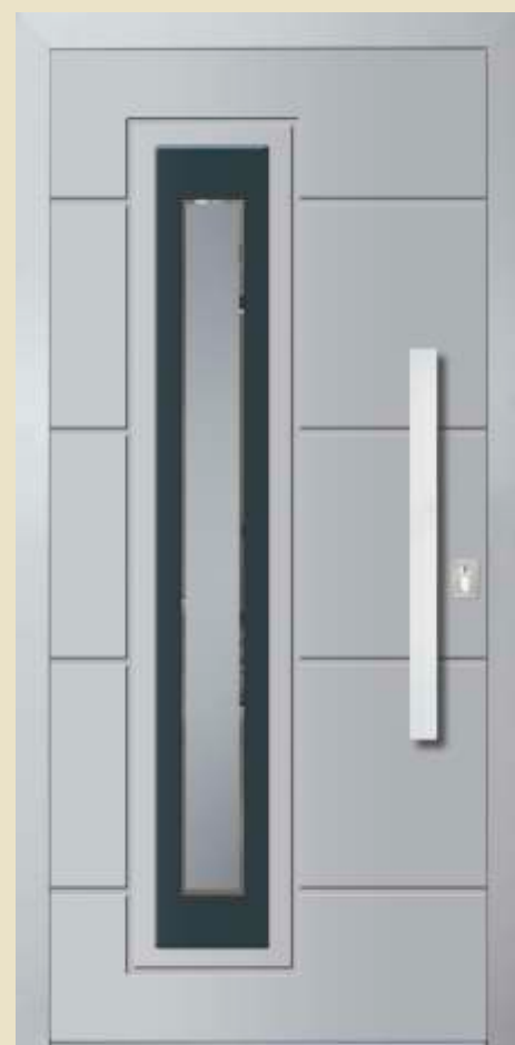
vanjska ploča AL 9006 sjaj unutrašnja ploča AL 9006 sjaj staklo FPK - pjeskareni motiv na float staklu aplikacija Planibel sivi 6mm kaljeno/emajlirano RAL 7024 rukohvat DPS 750h rozeta RKP 50
